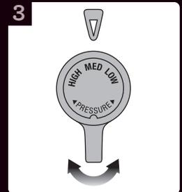
3 Choisir le réglage de pression à l'aide du cadran de contrôle sur la poignée (basse, moyenne ou élevée)
